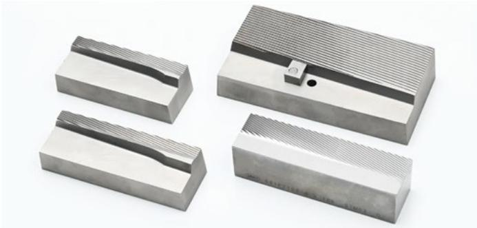
転造平ダイスはセッティング(調子出し)時間を大幅に短縮し、長寿命。
